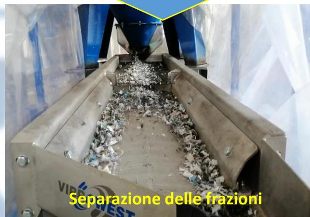
Il trattamento criomeccanico include la stabilizzazione termica con azoto liquido, la frantumazione e la successiva separazione di frazioni ferrose, residui plastici e polvere elettrodica.
